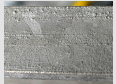
➔ Abb. 5: Unebene Zinkoberfläche durch Ungänzen im Stahlwerkstoff.
