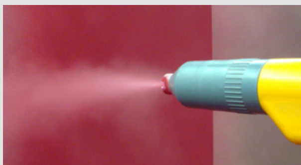
Abb. 1: Applikation des Pulverlackes durch Sprühen
